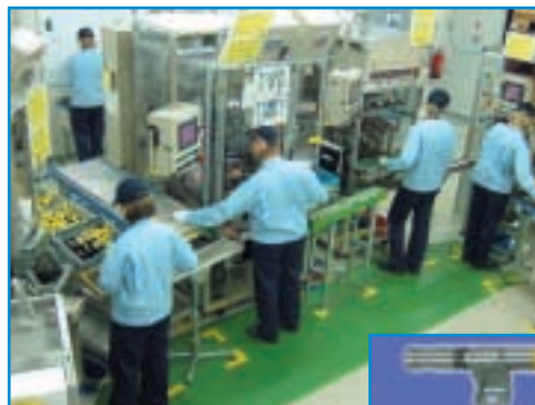
パイロインフレーターの 製造ライン
